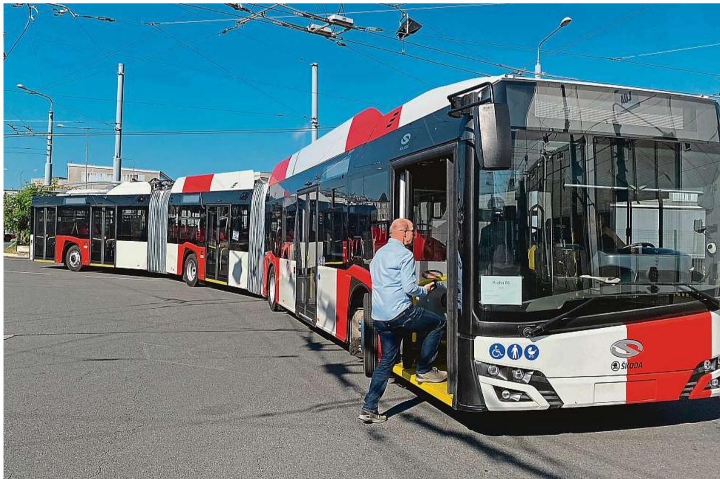
Dlouhý trolejbus Na pražské letiště bude příští rok jezdit trolejbus s označením Škoda 38, který se svou délkou skoro 26 metrů nabídne dostatek místa pro cestující i turisty s kufry. Výjimečný je i svým pohonem. Dva motory pohánějí druhou a třetí nápravu. Foto: Petr Ježek, MF DNES
